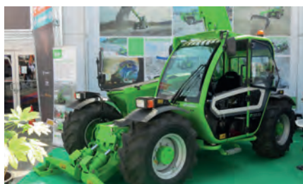
La marca italiana, exhibió alguno de sus modelos de la gama EE de manipuladores telescópicos modulares con capacidades de hasta 4.200 kilos.
